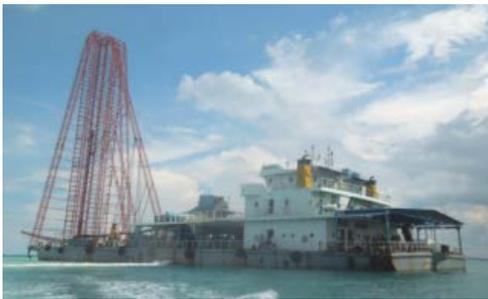
Gambar 1. Kapal hisap produksi *bore hole mining*
